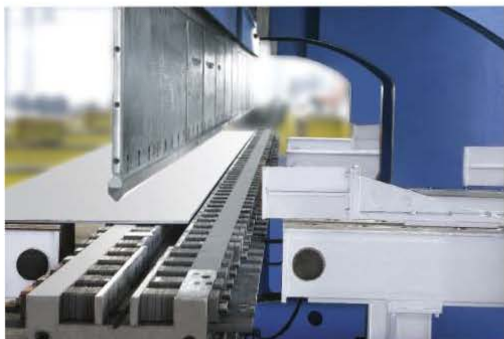
Prismatic top tooling, adjustable slotted bottom tooling Outillage prismatique pour le haut, ouverture ajustable pour la matrice
